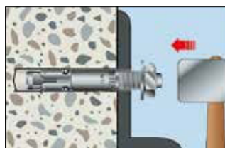
3. Svorníkovou kotvu vložte do kotveného stavebního dílu a zašroubujte.
