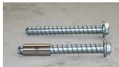
Na kotvu lze nasunout pouzdro v celé jeho délce, šroub pak již není vhodný pro další použití
