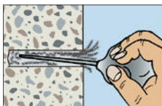
2. Vyvrtaný otvor vyčistěte.
