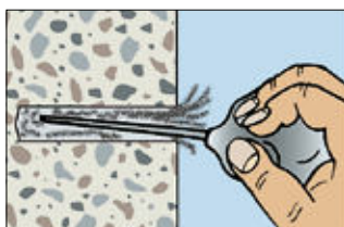
2. Vyvrtaný otvor vyčistěte.
