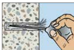
2. Vyvrtný otvor vyčistěte.
