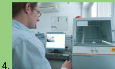
Přístroj na měření tloušťky povrchové vrstvy Měření síly vrstvy pomocí rentgenově fluorescenční analýzy podle ISO 3497
