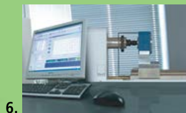
Zkušební zařízení na měření hodnoty tření a točícího momentu. - Hodnoty tření podle ISO 16047 - Točící moment/zkouška síly předpětí - Torzní zkouška, stanovení svěrného momentu a momentu zlomení
